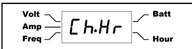
欲結束本設定模式有兩種方式，其一為按下【設定】鍵持續4秒，直到顯示幕出現【End.】字樣，代表完成該次設定。其二為當盤面按鍵連續30秒未被觸動，AMF-10模組將自動視同結束本次設定，顯示幕出現【End.】字樣，代表完成該次設定，並將螢幕最終顯示值予以記憶儲存。
